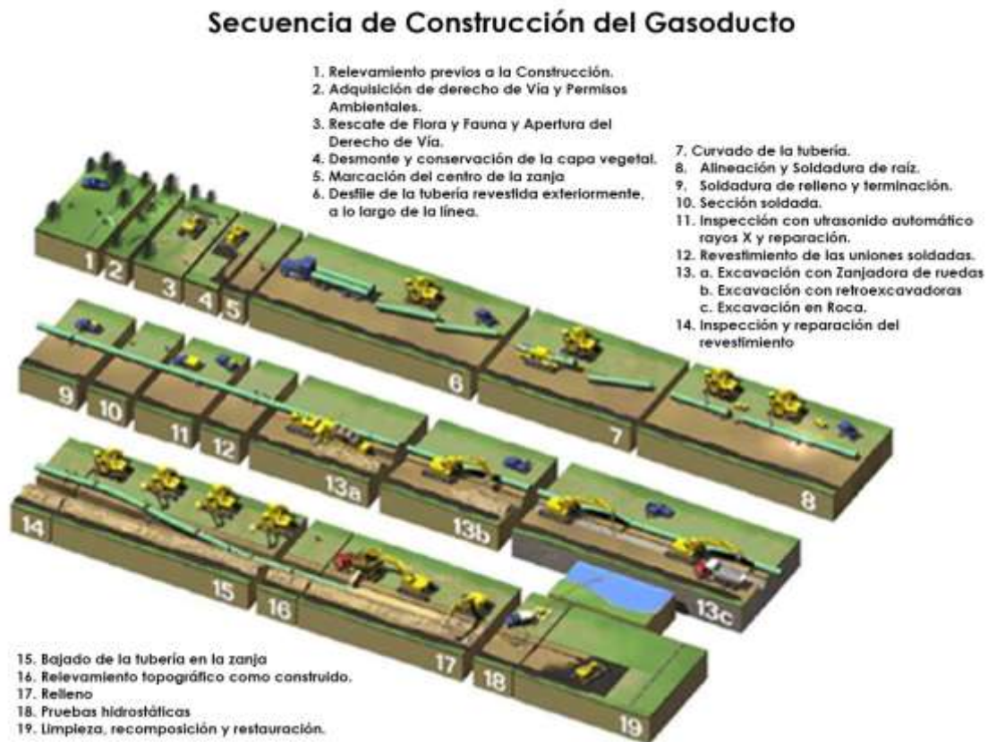
Figura 122. Secuencia de Construcción del Proyecto. En esta figura se resume en forma esquematizada las fases de construcción.
